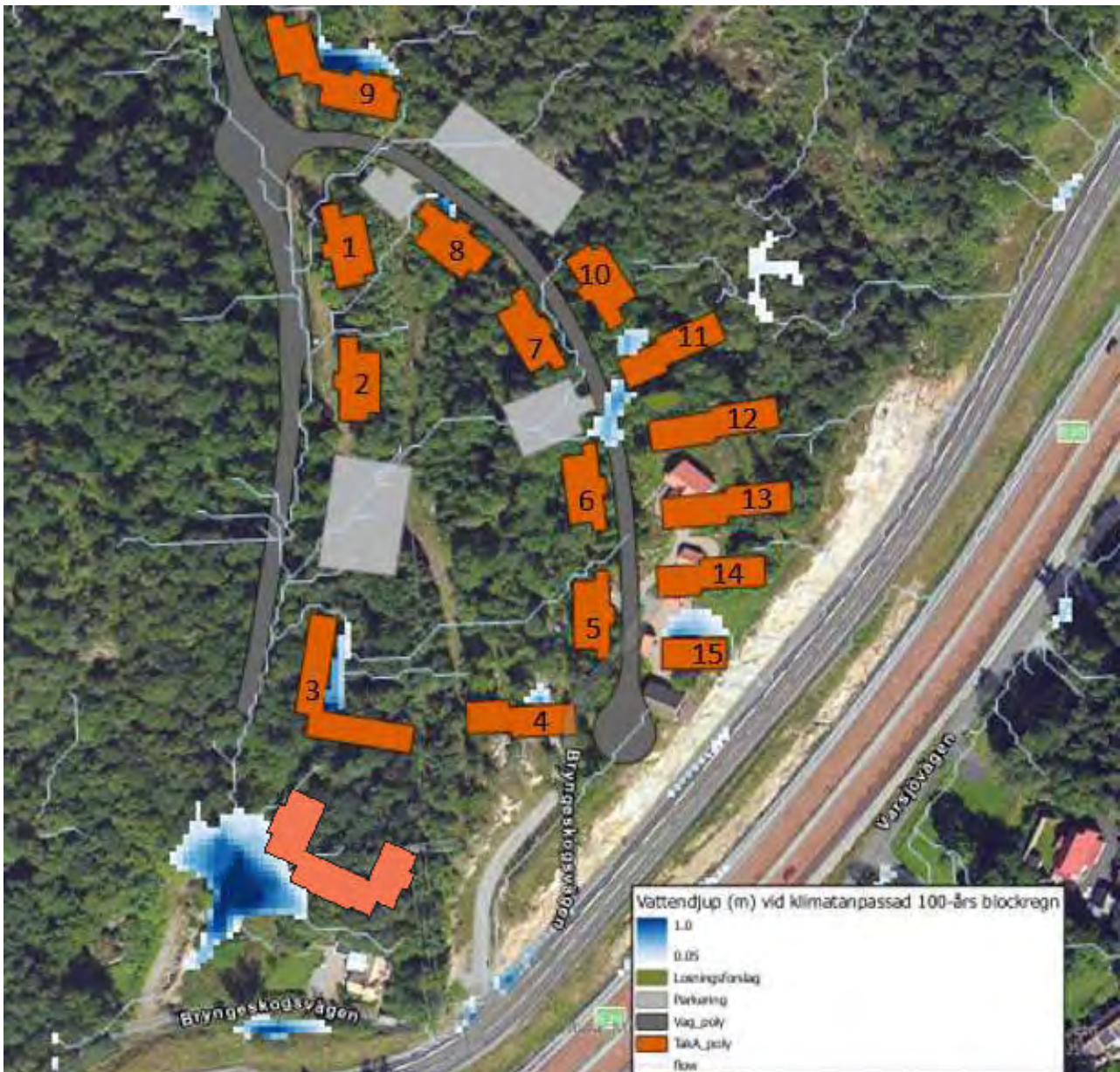
Figur 314. Skyfallsmodell över hur ett 100-årsregn drabbar blivande bebyggelse med nuvarande markhöjder. Källa: COWI 2021. Efter samrådet har ytterligare en byggnadskropp tillkommit i söder.
