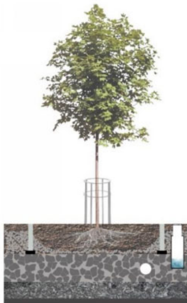
Figur 12. Antagen uppbyggnad av skelettjord (Stormtac)
