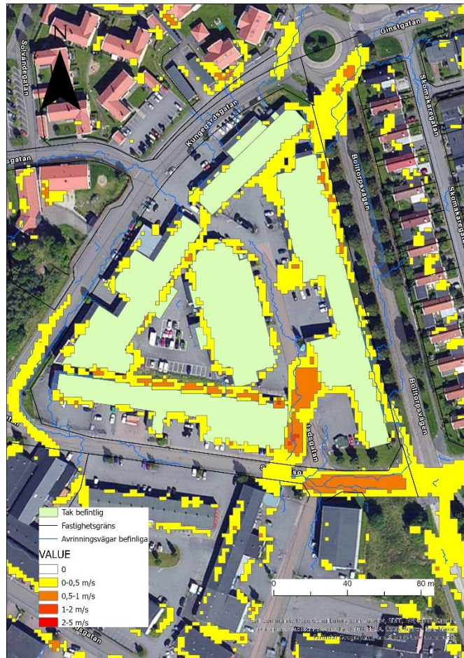
Figur 8. Maxhastighet (m/s) vid ett klimatanpassat 100-årsregn. Mörkare områden drabbas av snabbare hastighet. Avrinningsvägar i blått är från SCALGO Live.
