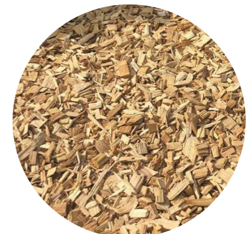
TRÄFLIS SOM FALLSKYDD PÅ LEKPLATS
