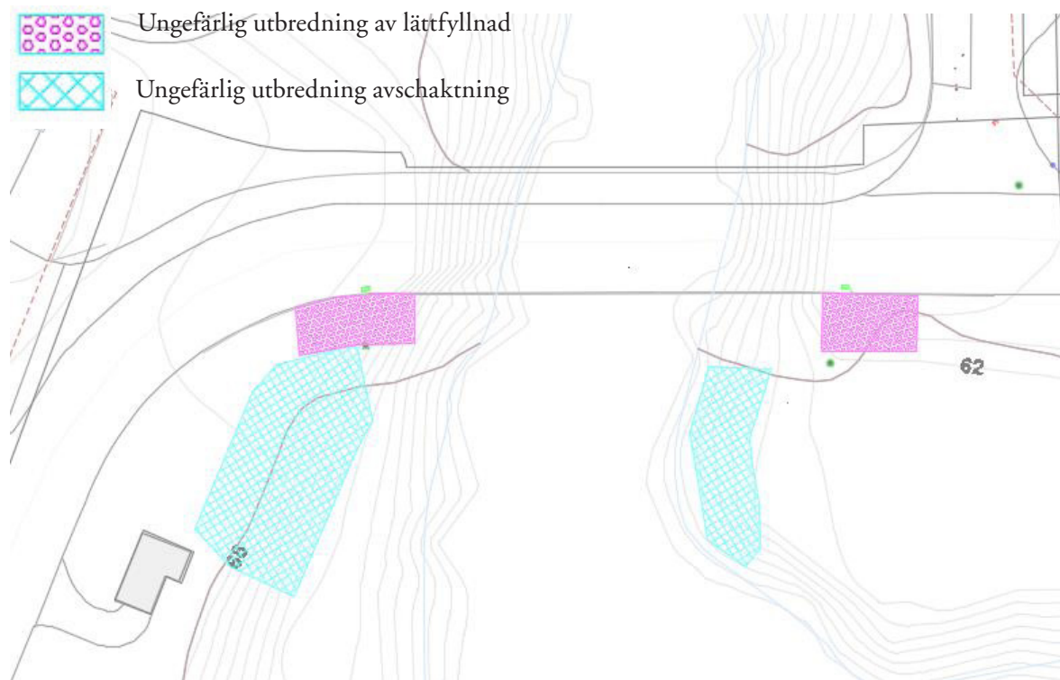
Ungefärlig utbredning av geotekniska åtgärder för breddning av bro (ÅF 2019).
