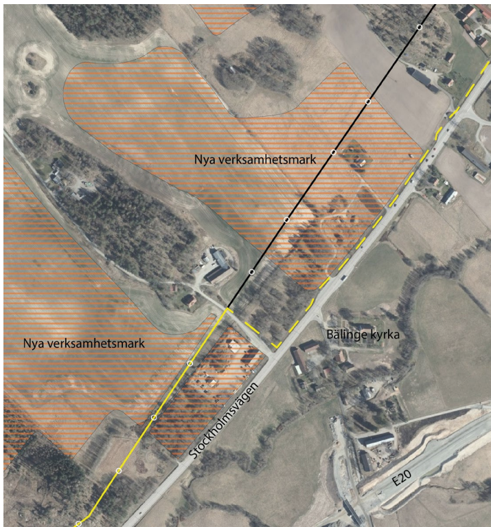
Figur 29. Föreslagen markförläggning i gul streckat. Svart sträckning föreslås raseras. Befintlig sträckning i gul heldragen linje.
