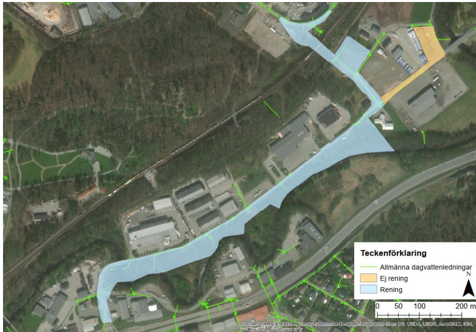
Figur 10. De delar av befintliga och planerade hårdgjorda ytor där dagvattenrening föreslås. Notera att reningen avser vägdagvattnet.
