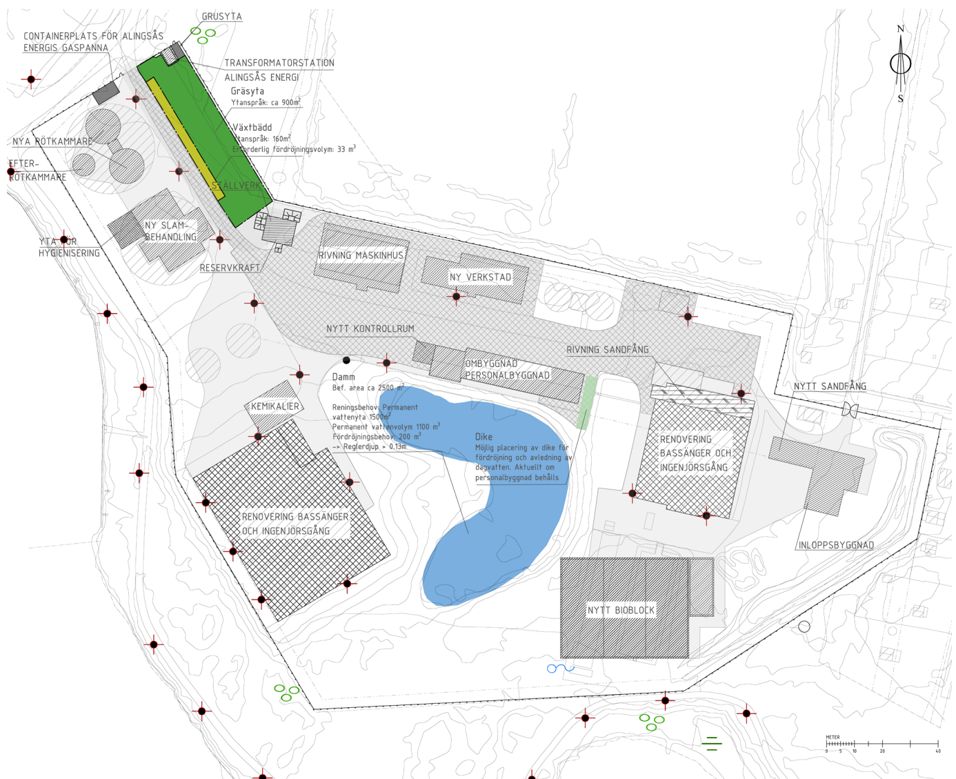
Figur 10. Föreslagen dagvattenhantering utifrån ett möjligt scenario efter ombyggnation (Ramboll, 2021)
