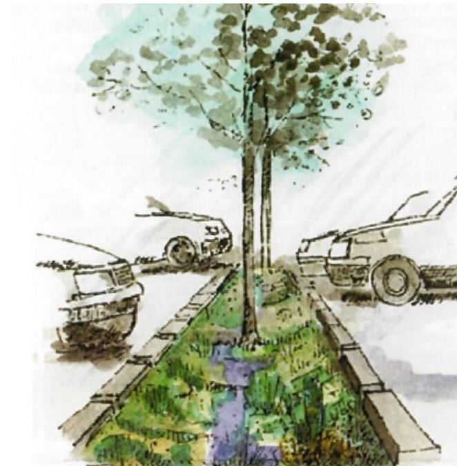
Fig. 67 Skiss på hur infiltrationsytor kan skapas vid parkeringsplatser (illustration Pekka Kärppä)
