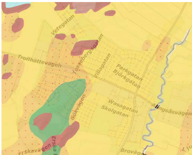
Fig. 18 Sollebrunns jordarter består främst av lera (gult) med inslag av grus och jord (orange). Isälvs sediment (grönt) och berg (rött) förekommer också.
