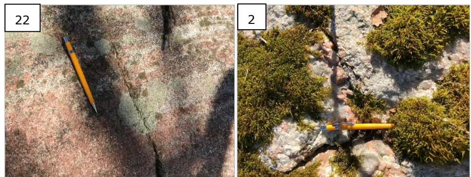
Figur 7. 22) Medelkornig granitisk gnejs med foliations-struktur. 2) Grovkornig pegmatit.
