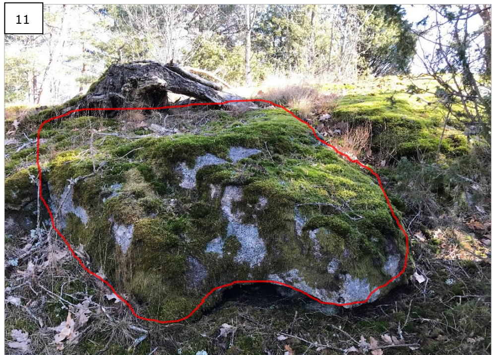
Figur 10. Block vid observationspunkt 11 riskerar att glida ut längs en flack spricka.
