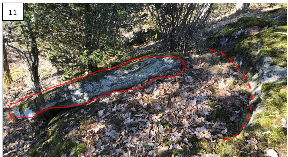
Figur 11. Ett block har tidigare glidit ut i slänten och är fastkilad mot två träd, vid observationspunkt 11.
